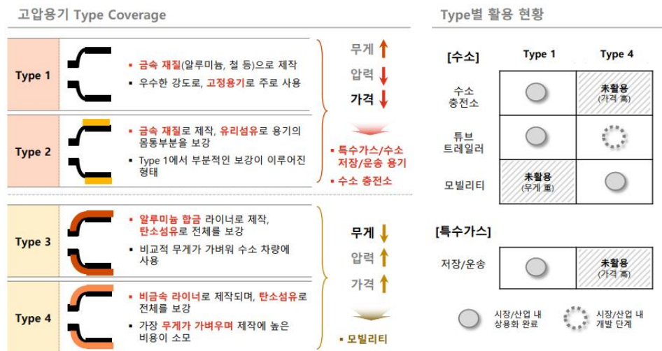
<그림31> 덕산에테르씨티 Type별 고압용기
