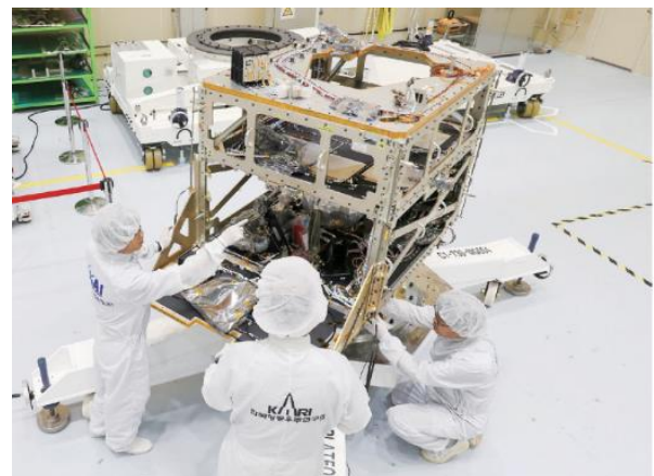
그림 164. 조립 중인 차세대중형위성
